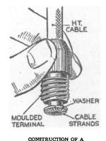
CONSTRUCTION OF A TYPICAL H.T. TERMINAL.
