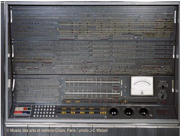
Figure 4: "Ordinateur IBM type Stretch: console de maintenance" (IBM 31 / 7101) ("Stretch" Supercomputer Central Processing Unit), 1962, Copper, aluminum, steel, plastic, 174 x 163 x 175 cm, [Musée des arts et métiers](https://www.musee-lam.fr/), Paris, Collection Instruments scientifiques © Musée des arts et métiers-Cnam, Paris / photo J-C Wetzel. (<https://phototheque.arts-et-metiers.net/>).
