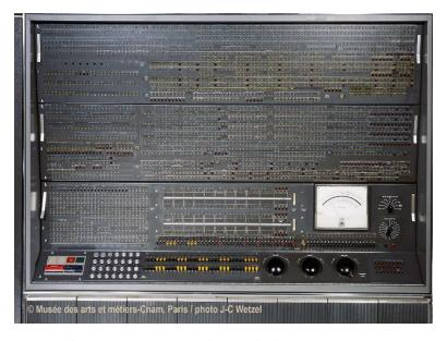
Figure 4: "Ordinateur IBM type Stretch: console de maintenance" (IBM 31 / 7101) ("Stretch" Supercomputer Central Processing Unit), 1962, Copper, aluminum, steel, plastic, 174 x 163 x 175 cm, Musée des arts et métiers, Paris, Collection Instruments scientifiques © Musée des arts et métiers-Cnam, Paris / photo J-C Wetzel. (https://phototheque.arts-et-metiers.net).
